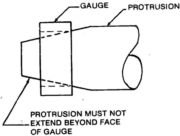
**FIGURE 6 - PROTRUSION TEST**
