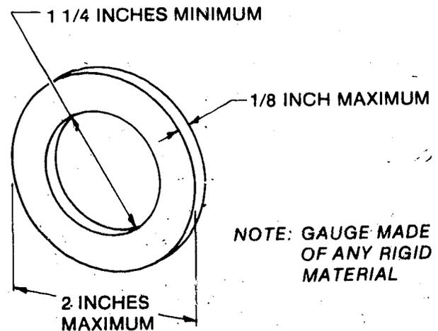
**FIGURE 7 - PROTRUSION TEST GAUGE FOR SUSPENDED SWING ASSEMBLIES**
