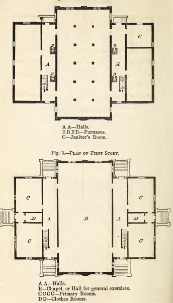
Fig. 2.-PLAN OF BASEMENT.
