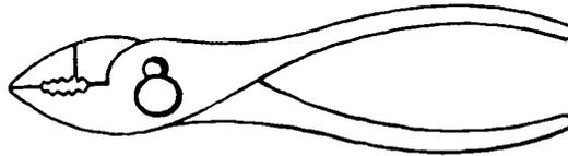
FIGURE 77. Slip-joint Pliers
