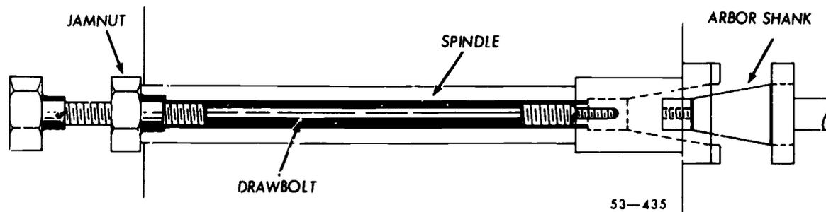
Figure 5 Spindle drawbolt.
