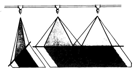
NOZZLES SHOULD BE ALIGNED PARALLEL WITH THE BOOM
